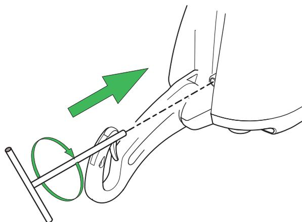
Inserire l'utensile speciale nell'apertura. Ruotarlo in senso orario per abbassare il paziente. L'utensile ruota il motore direttamente, in modo che ad ogni giro abbassi leggermente il paziente.
