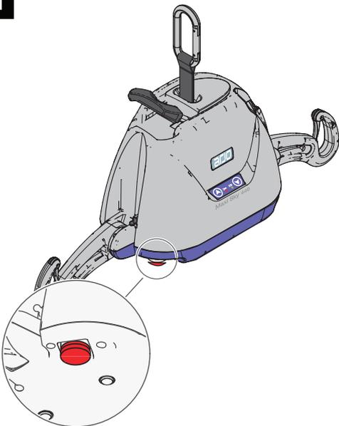
L'operatore può disattivare l'alimentazione elettrica in qualsiasi momento premendo il tasto rosso di emergenza a forma di fungo situato sotto il sollevapazienti.
